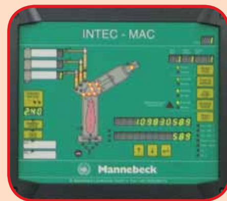
El controlador de estación de alimentación MAC INTEC permite que los productores de cerdos tengan acceso directo a todas las funciones de la estación de alimentación a través de la interfaz visual fácil de utilizar.
